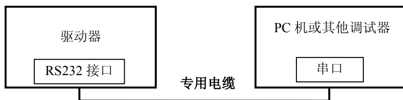
图 5 参数调试接线原理图
