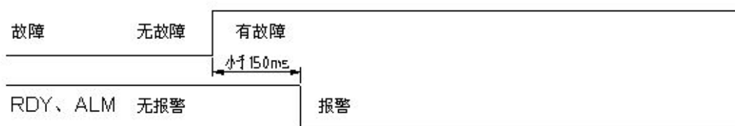
图 7-2 驱动器报警时序图
