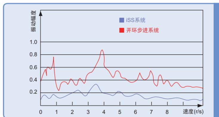
○ 超低速度下运行时的电机振动
